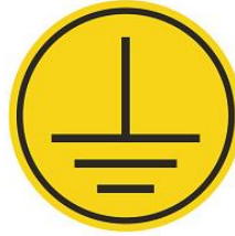
Figura 5 Marcación señal de puesta a tierra
